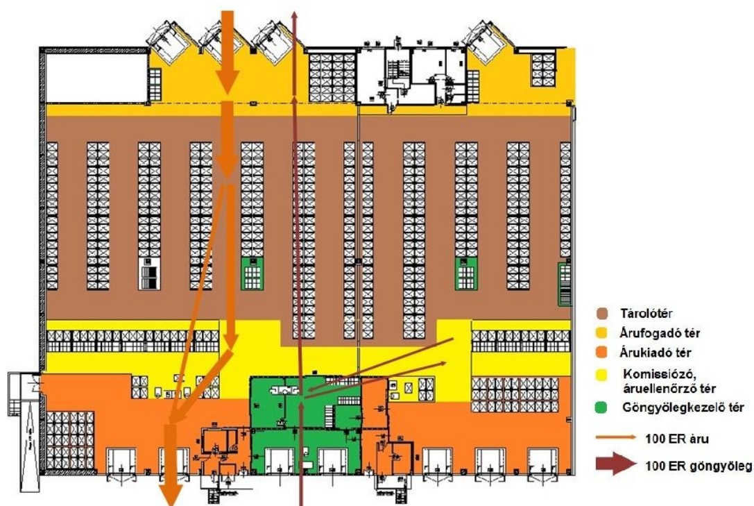
17. ábra: A normál folyosós raktárterv funkcionális területei és anyagáramlása
